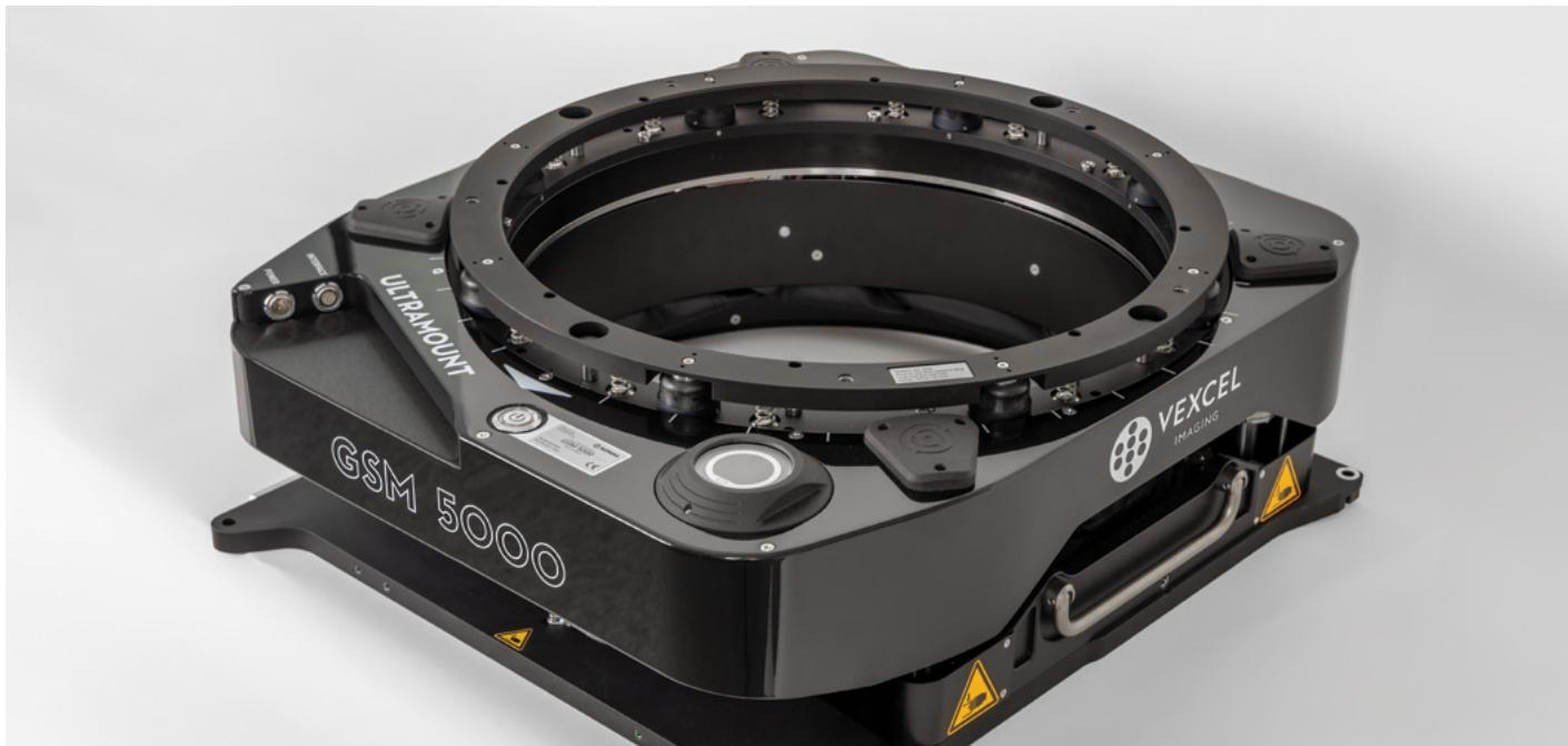
O UltraMount GSM 5000 é uma plataforma de estabilização giroscópica de última geração que mantém a UltraCam estável durante as operações aéreas. Instalado na fuselagem da aeronave, o seu cardan de 3 eixos compensa automaticamente a deriva, a inclinação lateral e a inclinação longitudinal em tempo real, mantendo o sistema nivelado e as exposições perfeitamente alinhadas. Compatível com todos os modelos UltraCam, o UltraMount integra-se perfeitamente e oferece uma interface de fácil
