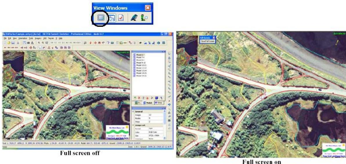
Puede observarse a la derecha la pantalla completa en estéreo, y dos ventanas flotantes también en estéreo con una vista de detalle (que nos permite ahorrar tiempo en zooms innecesarios) y otra de la zona o modelo en observación.
